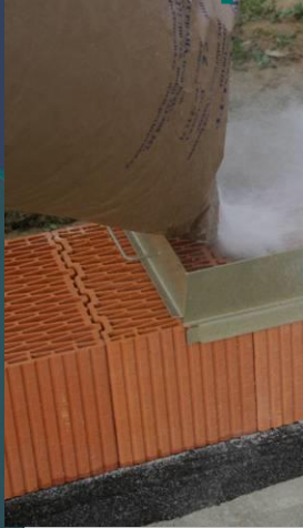
Výroba cihel Porotherm T Profi plněných minerální vatou
