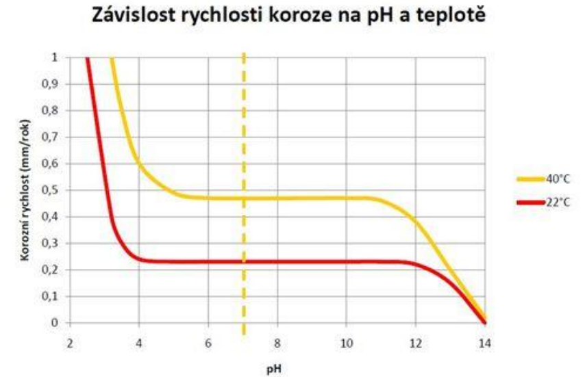
Obr. 3 Závislost korozní rychlosti nelegované oceli ve vodě s obsahem rozpuštěného kyslíku na pH při různé teplotě.
