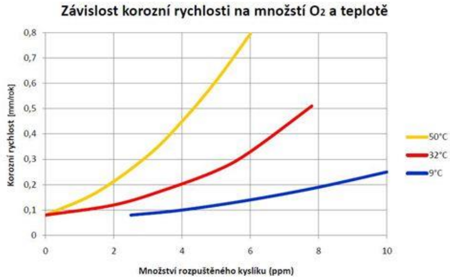
Obr. 4 Vliv rozpuštěného kyslíku ve vodě na korozní rychlost nelegované oceli za různých teplot
