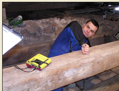
Vztah mezi rychlostí šíření UZ vlny a poškozením smrkového dřeva
