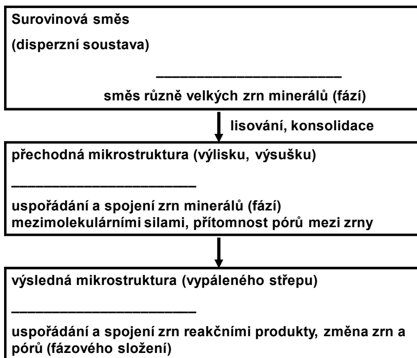
Obr. 4.3 Schematické znázornění vzniku mikrostruktury keramického střepu.
