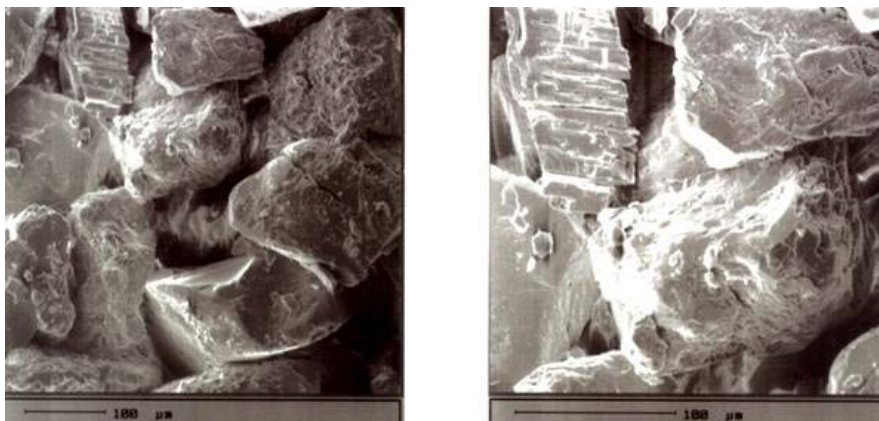
Obr. 4.8 Porézní struktura pískovce, měřeno elektronovým mikroskopem.
