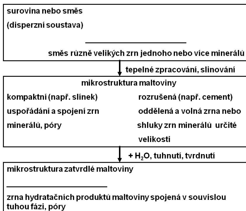
Obr. 4.3 Schematické znázornění vzniku mikrostruktury keramického střepu.
