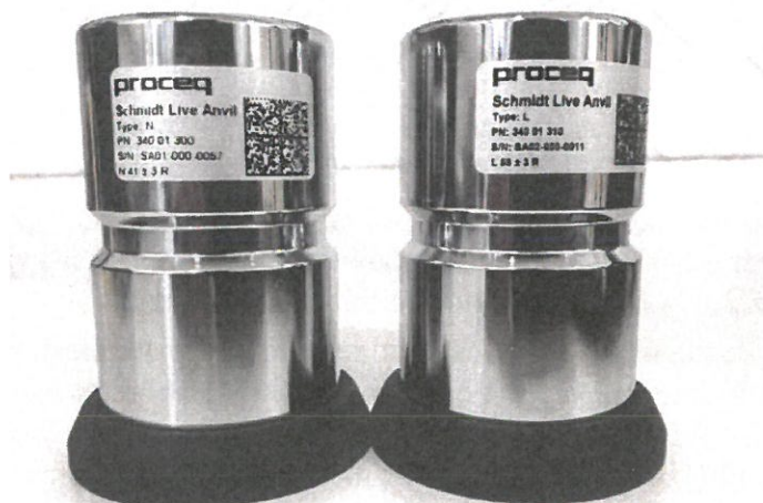
Obr. 4.6 Kalibrační kovadliny malé, zvláště pro Schmidt Live N a L, pro zkoušení in situ.
